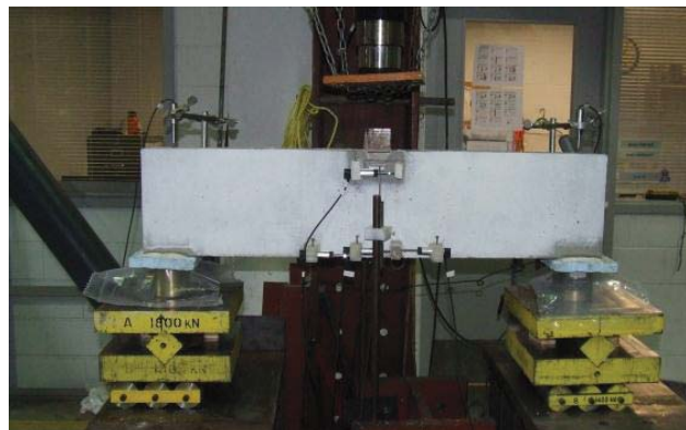
Figure 39 : Dispositif expérimental pour les essais de flexion 3 points
