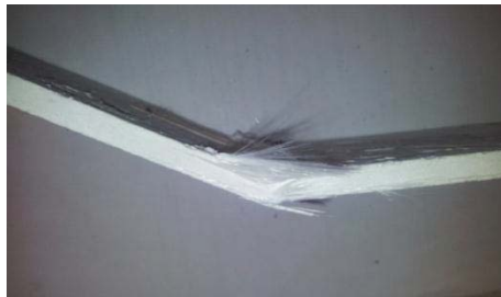
Figure 22 : Déchaussement des fibres du faisceau
