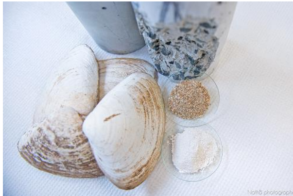
Figure 1 Illustration des résidus marins entrant dans la recette de bétons pour trottoirs.
