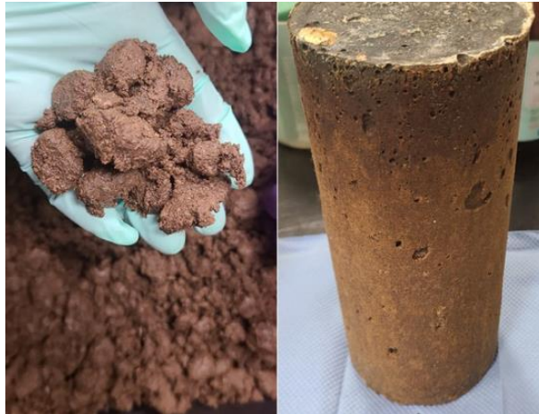
Figure 5 Illustration de la recette de béton-géopolymère optimisée avec la gâchée après mélange à gauche et un cylindre après démoulage à droite.
