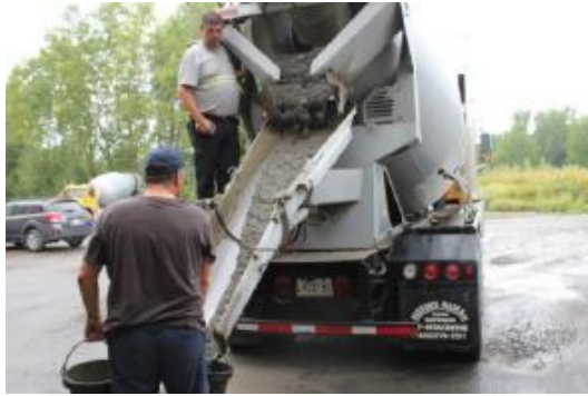
Figure 2 Illustration de l'essai de 1 m 3 réalisé dans un camion à béton.
