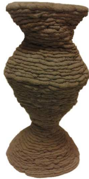
Figure 4: Impression des surfaces inclinées.
