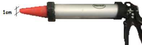
Figure1: Matériel (pistolet et buse) utilisé pour l'impression manuelle du mortier.
