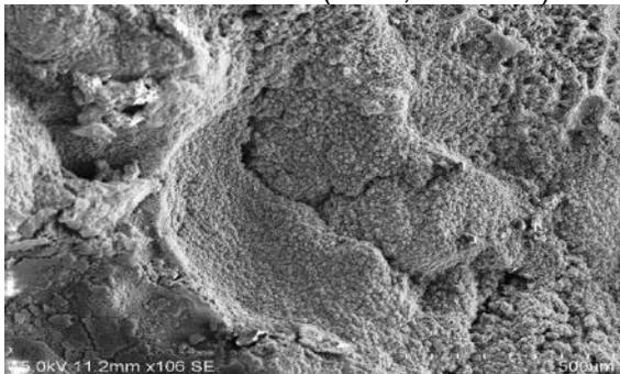
b) Microstructure des surfaces des fissures cicatrisées des mortiers à faible potentiel d'autocicatrisation (10KFA9; 10KFA17)
