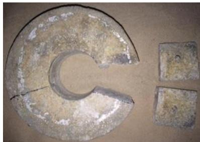
Figure 3. Préparation des surfaces internes des fissures cicatrisées pour observation au MEB
