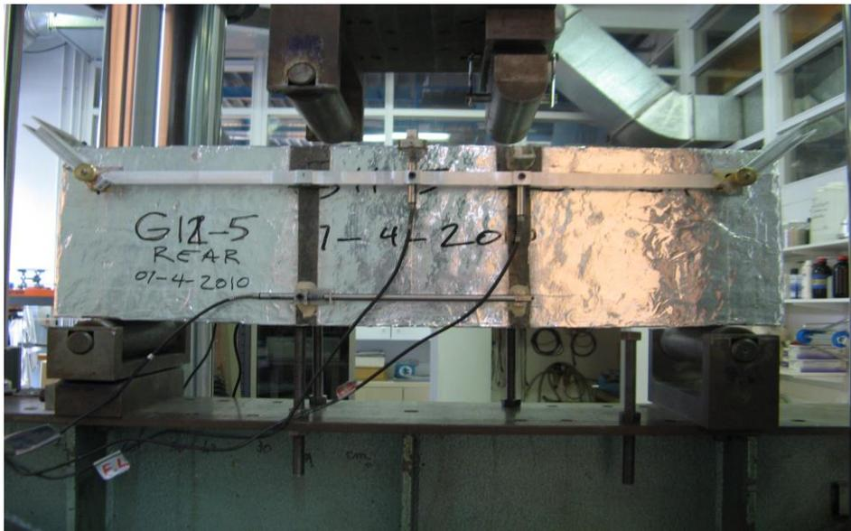
Figure 1. Montage d'essai pour le pliage essai de fluage sur éprouvettes fissurées
